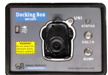
Estação de ancoragem UNI
